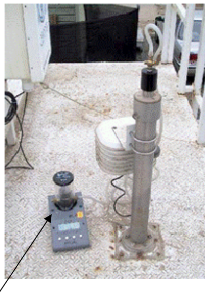
Uso de calibrador en cabezal Beta MP10
