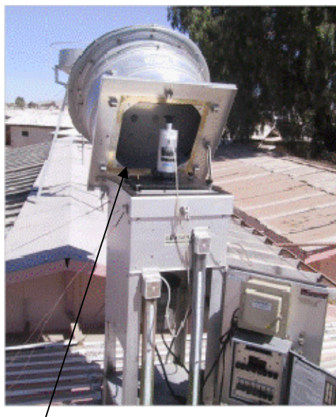
Uso de Variflo en muestreador de alto volumen MP10
