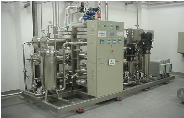
Figura 1: Sistema Avanzados de electrodesionización "ORION", combina tecnología de osmosis inversa y electrodesionización en continuo en sistemas sanitizables.
