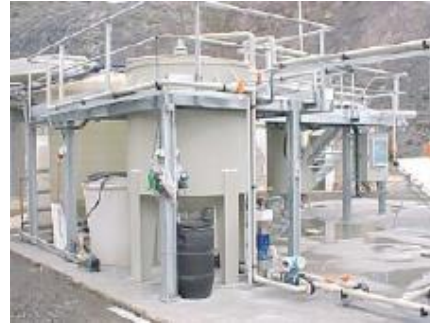
Figura 2: Combinación fotofenton-BRI, Almería (España).
