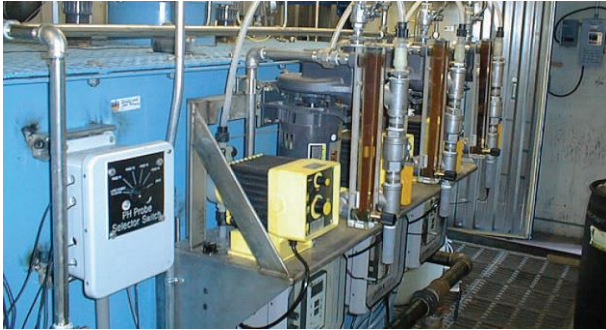
Figura 1: Tecnología de biorreactor de células inmovilizadas UOP.
