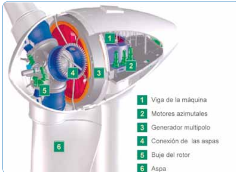
Figura 8 : Aerogenerador con generador multipolo y sin caja multiplicadora
