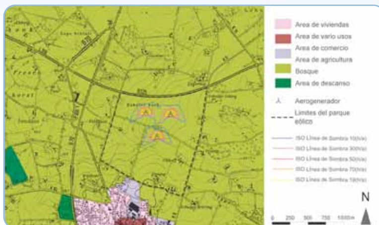
Figura 20: Ejemplo de un pronóstico de la presentación de sombra para condiciones reales 10
