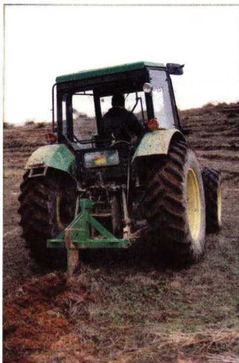
**FIGURA 3:** Preparación de suelo con subsolado con uso de maquinaria.
