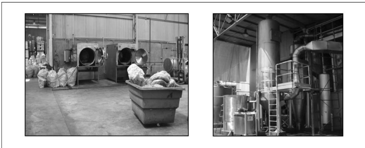
FIGURA 17: MATERIAL RESIDUAL Y AUTOCLAVES AL FONDO (IZQUIERDA) Y EL HORNO PRINCIPAL (DERECHA)
