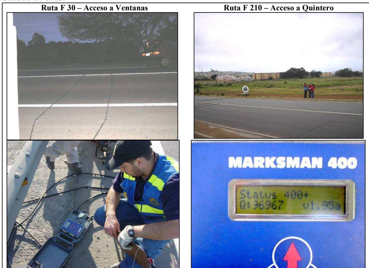
Figura 9. Disposición de Sensores Neumáticos e instrumental
