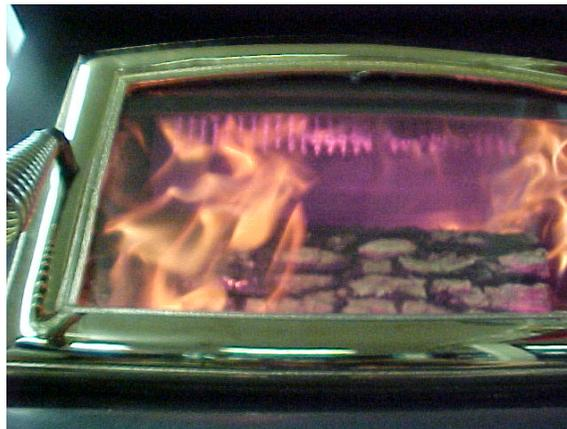
**Figura 5.2. Imagen tomada hacia arriba desde la puerta mostrando el catalizador con un color rojo incandescente en la parte superior de la cámara de combustión.**
