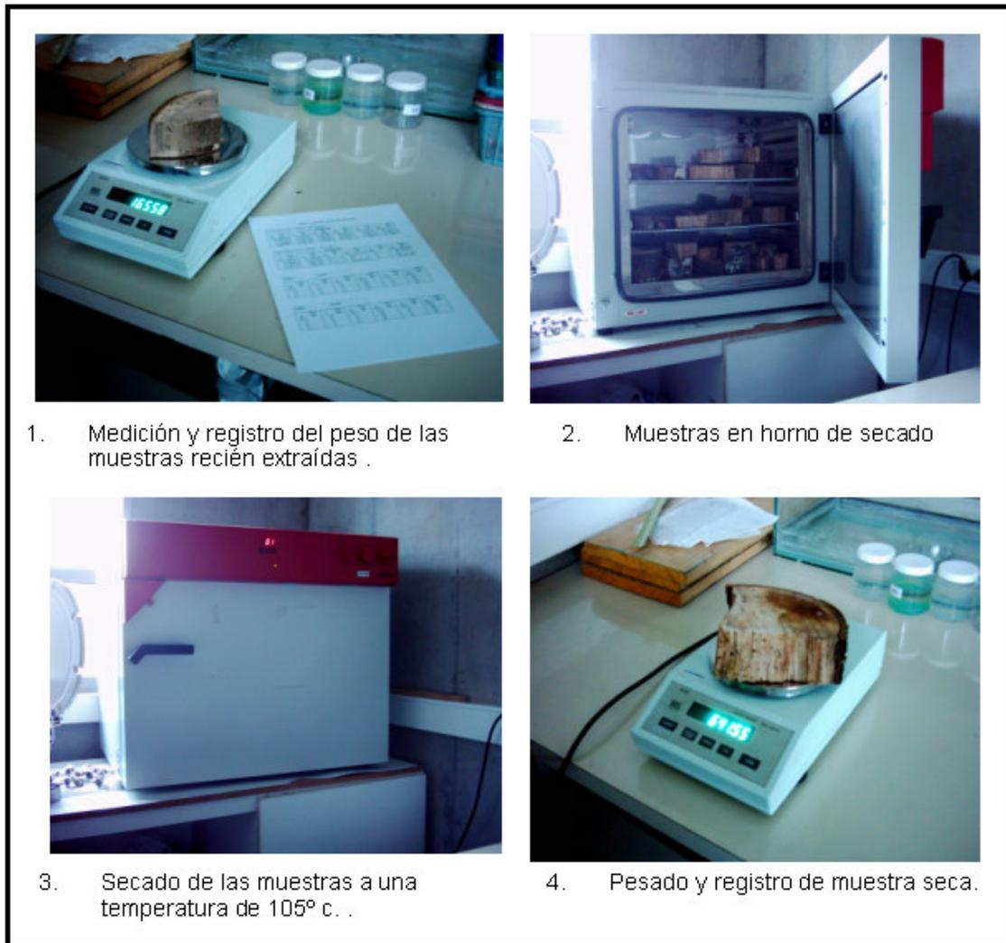
Figura 10. Secado en horno y pesaje de probetas.
