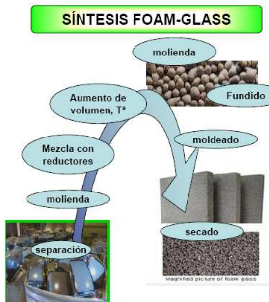
Figura 2.23 esquema fabricación foam glass (fuente Eco TV 2007)
