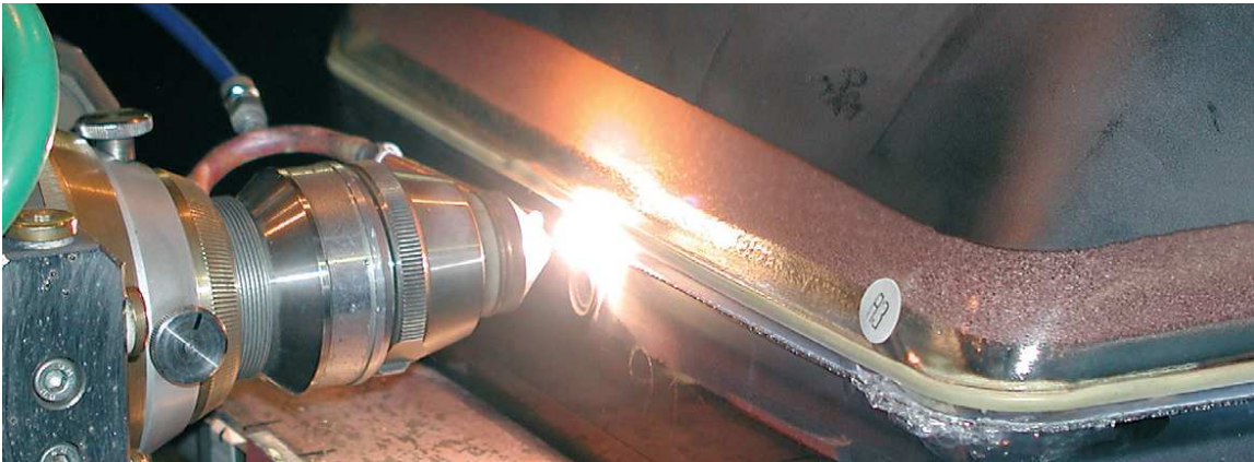
Figura 2.21 Corte del tubo de rayos catódicos con sistema laser (fuente: www.proventia.fi )
