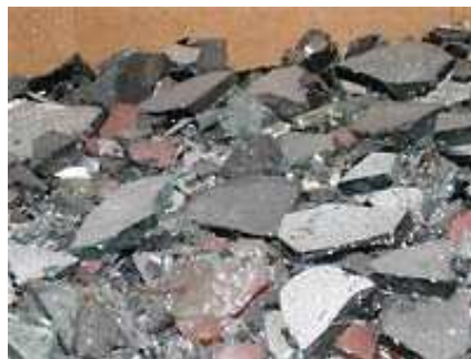
Figura 2.22 trituración del tubo de rayos catódicos (fuente: HRM Sacramento)
