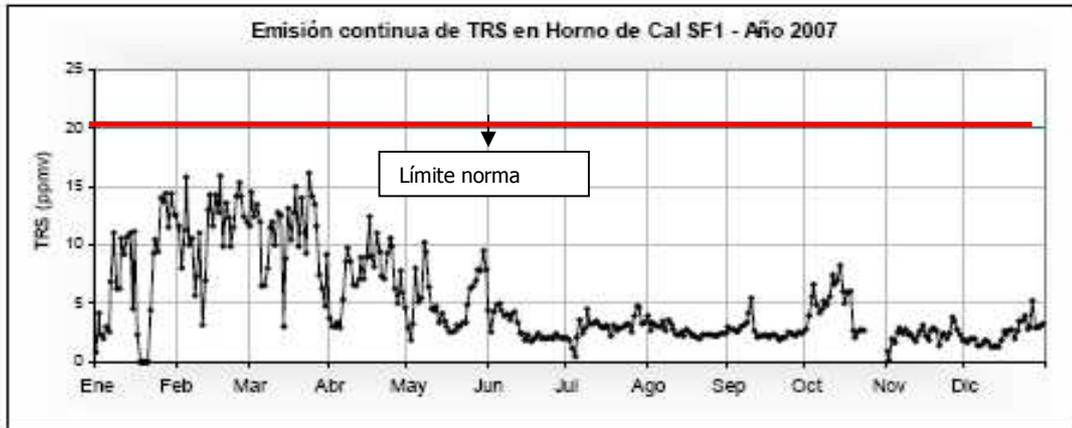
**Figura 21-10: Monitoreo de las emisiones de TRS del horno de cal de la línea 1 de la planta Santa Fe durante el periodo 2007.**
