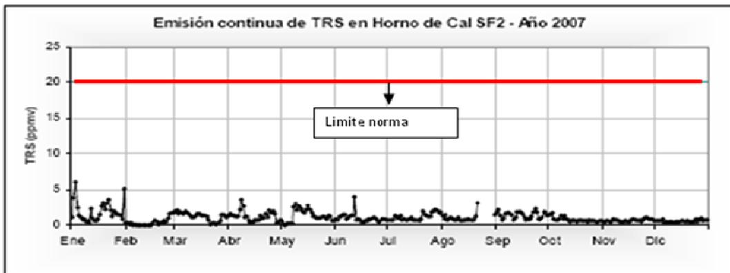
**Figura 21-11: Monitoreo de las emisiones de TRS del horno de cal de la línea 1 de la planta Santa Fe durante el periodo 2007.**
