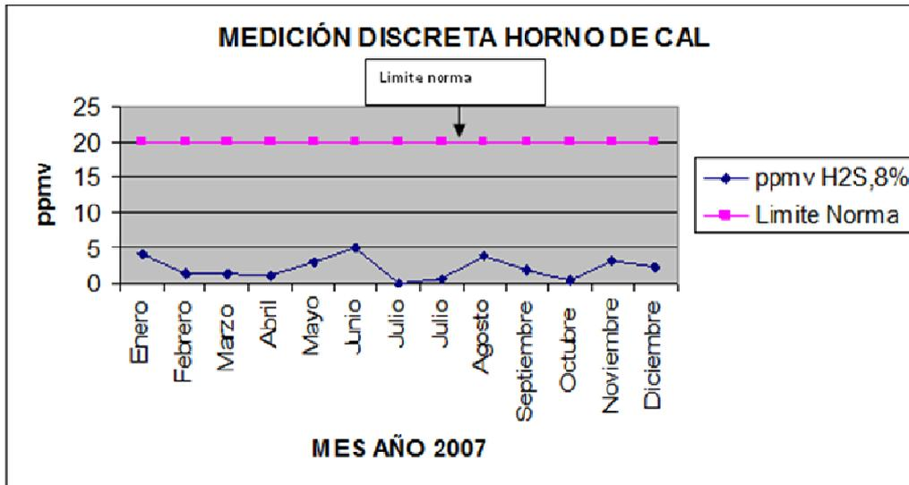
**Figura 21-8: Monitoreo de las emisiones de TRS del horno de cal de la línea 1 de la planta Arauco durante el periodo 2007**
