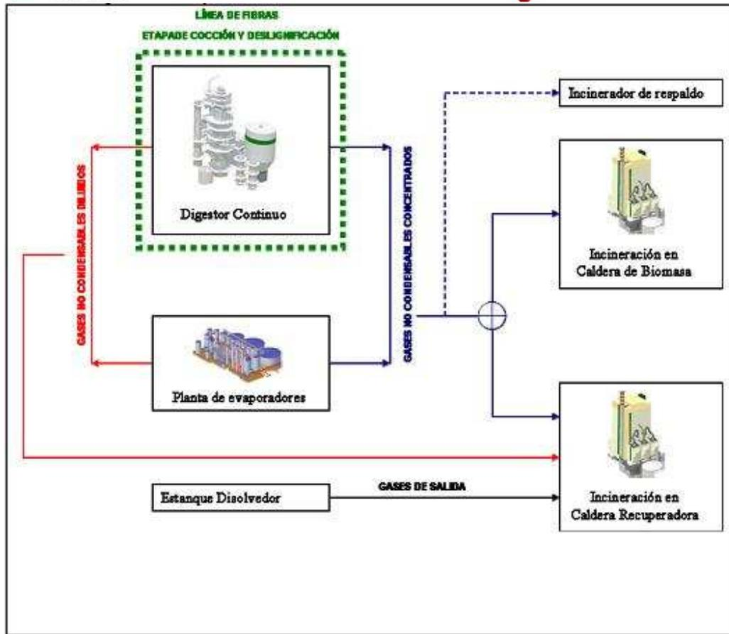
**Figura 21-2: Sistema recolector de gases con proyecto.**
