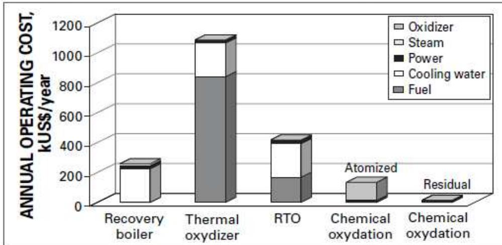
**Figura 21-6: Costos de operación por año para distintas medidas. Costos determinados para un flujo de 17000Nm<sup>3</sup>/h.**
