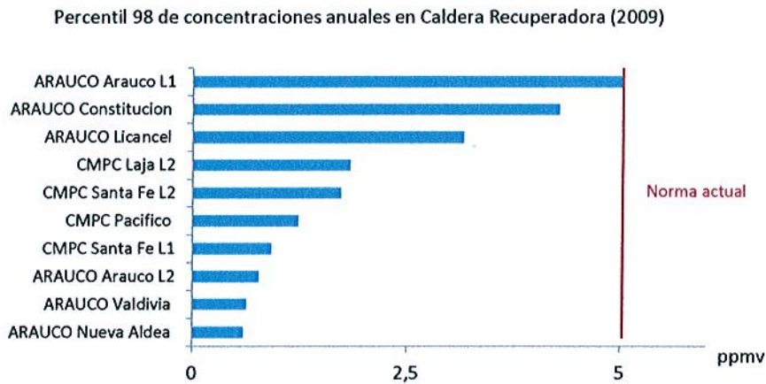
Figura 4-1. Cumplimiento de norma en Caldera Recuperadora
