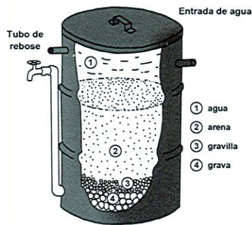
Figura 3: Tipos de filtros. Arena a la izquierda y a la derecha filtro de malla. En ambas figuras se detalla su estructura interior.
