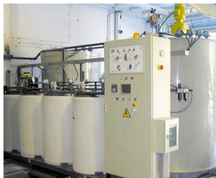
Figura 1: Planta de tratamiento de Boro a través de resina de intercambio iónico, Mekorot Israel National Water Co.
