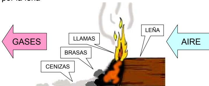
Figura 10. Configuración “downdraft”: el aire fluye desde la leña sin quemar hacia las brasas
