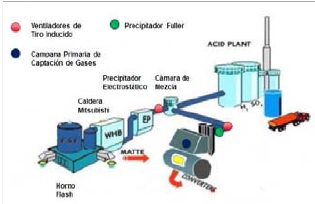
Figura 12.2.2 Manejo y limpieza de gases Fundición Chagres
