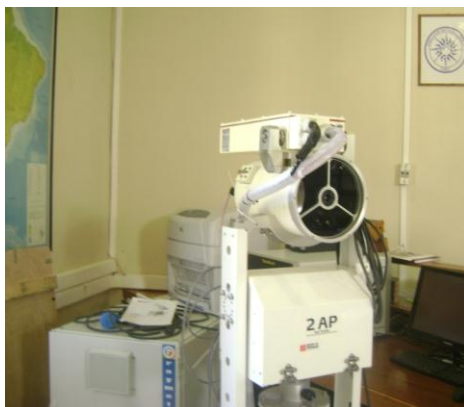
Figura 2-5: Observación de la atmósfera local, desarrollada por el equipo LIDAR en la estación de Quinta Normal, dependencias de la Dirección Meteorológica de Chile
