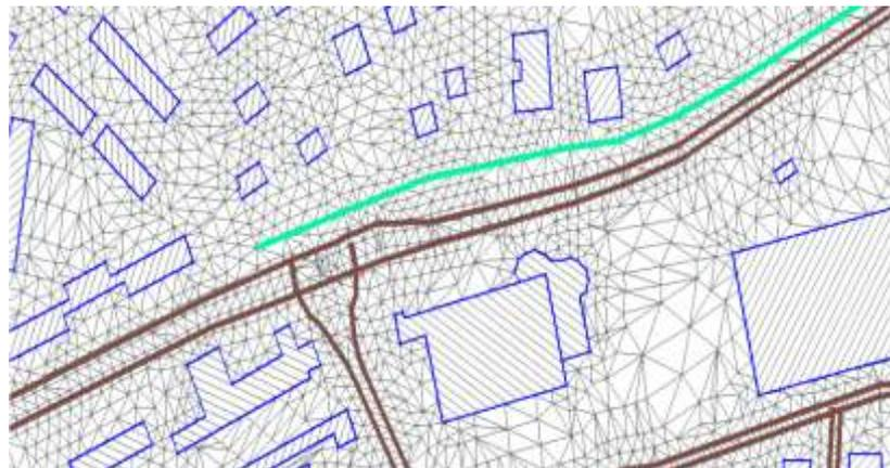
**Figura 4.1:** Ejemplo de método de reticulado no uniforme tipo malla mediante triangulación.
