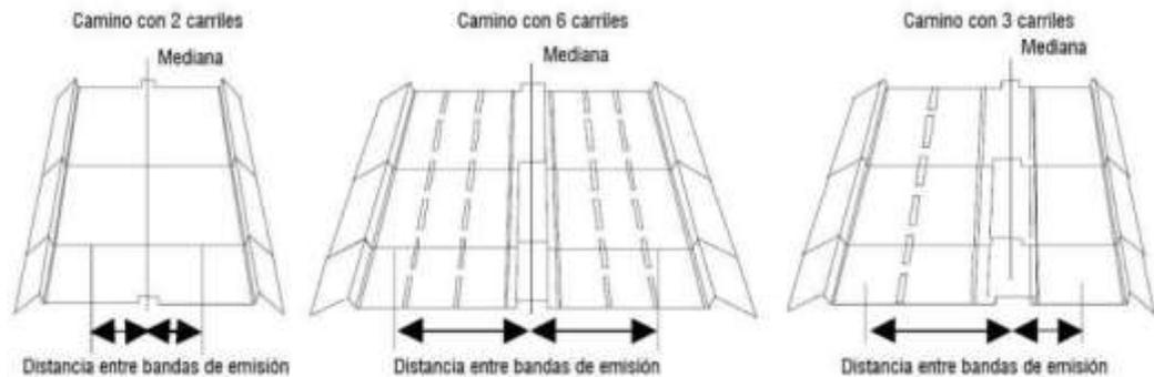
Figura 5.5: Tres diferentes tipos de perfil para calzadas.
