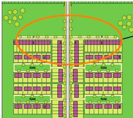
Frente cerrado de casas que forma una barrera acústica Fuente: Lärmkontor, BPW, konsalt, 2004, p. 30
