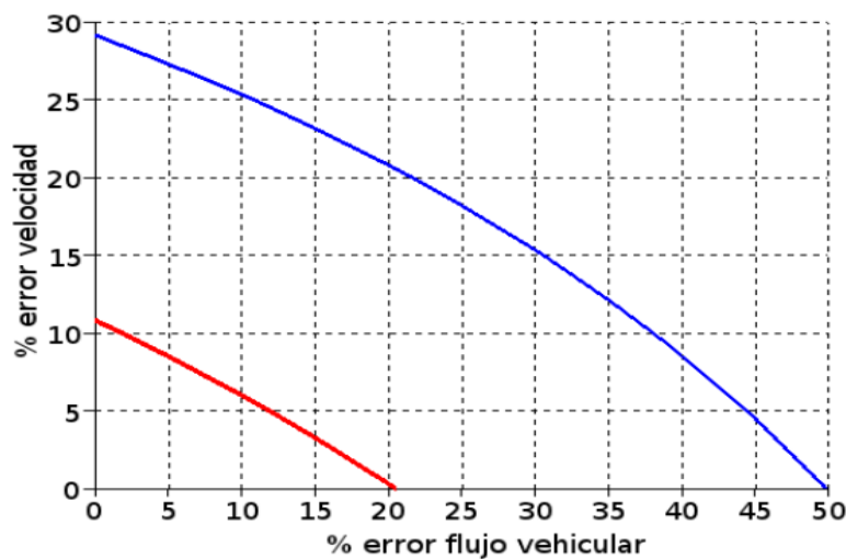
Fig. 4. Curvas de igual error en nivel de ruido en función de los errores en flujo y velocidad considerando el modelo de trenes SCHALL 03. Curva de color rojo corresponde a \pm 1 dBA, curva azul a \pm 3 dBA.
