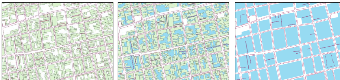
Fig. 20. Simplificación de edificaciones en condición de fachada discontinua.
