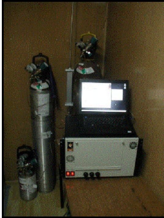
Figura 4. Instalación interior del Analizador Carbono Orgánico (Corg) y Carbono Elemental (Cele) en MP 2.5 Marca Sunset, Estación USACH.
