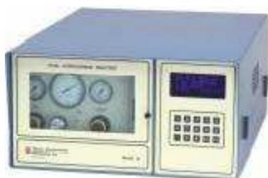
Se extrae una muestra de la fuente y se conduce por una línea de muestreo la que es calentada (sólo si se requiere), pasando por un filtro de fibra de vidrio antes del analizador de ionización de flama. Los resultados se informan como equivalentes de concentración de volumen del gas de calibración o como equivalentes de carbono.
