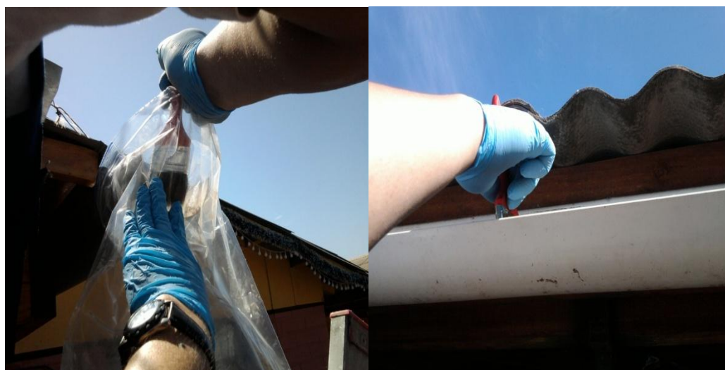
Figura A.3.8: Muestreo de polvo de techo.
