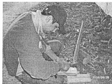
Medición en terreno del contenido de humedad de la leña apoyado con un xilohigrómetro.
