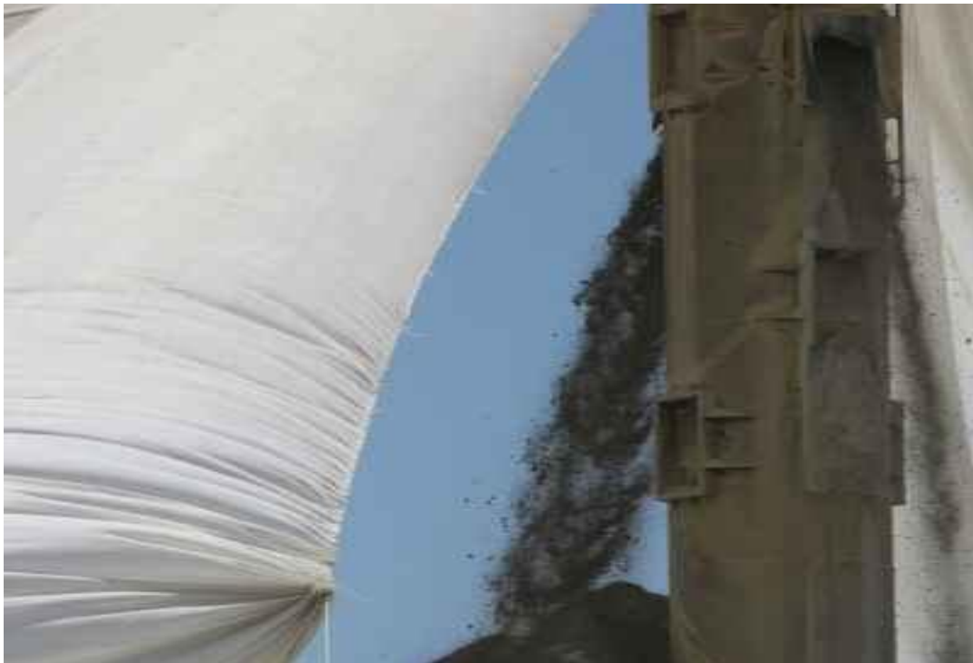
Figura 5-26. Manga Obstruida en Acopio Apolo
