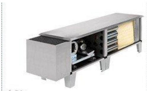
Filterkast met vetfilter, actiefkoolfilter en ventilatiesecties (v.r.n.l.)
