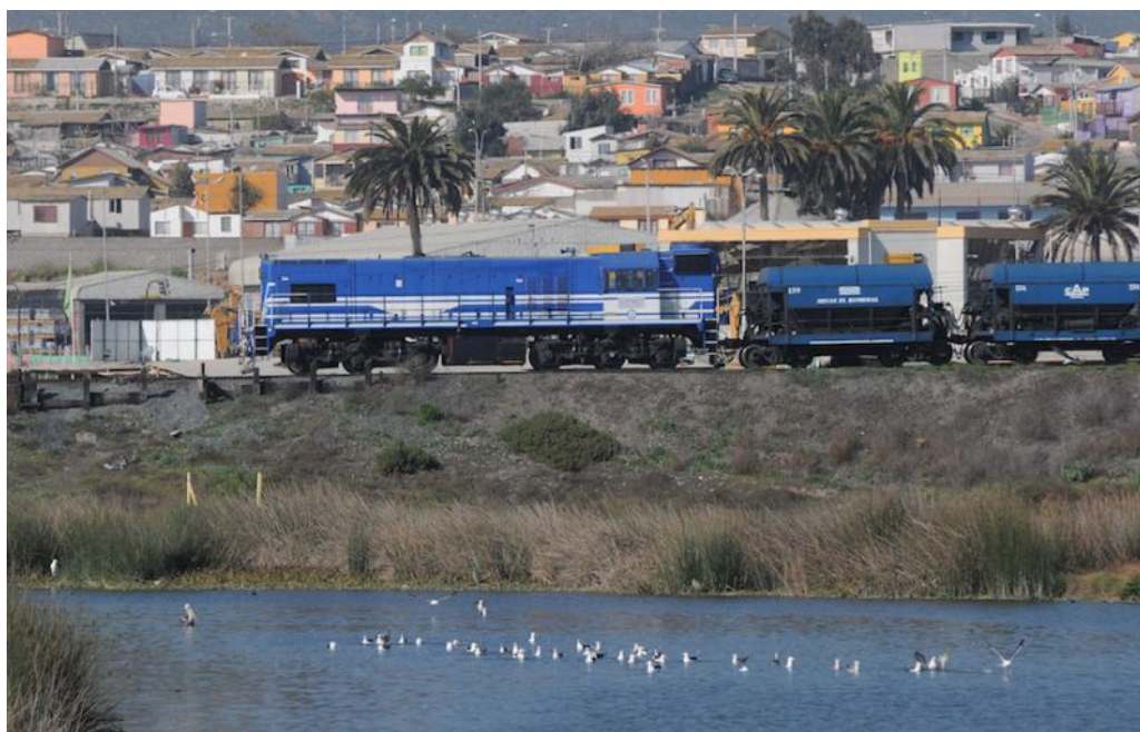
Fig. 91. Locomotora Modelo General Motor, Tipo GR-12, diesel eléctrica con carros Metaleros, Tipo Tolva, Socometal y HB.
